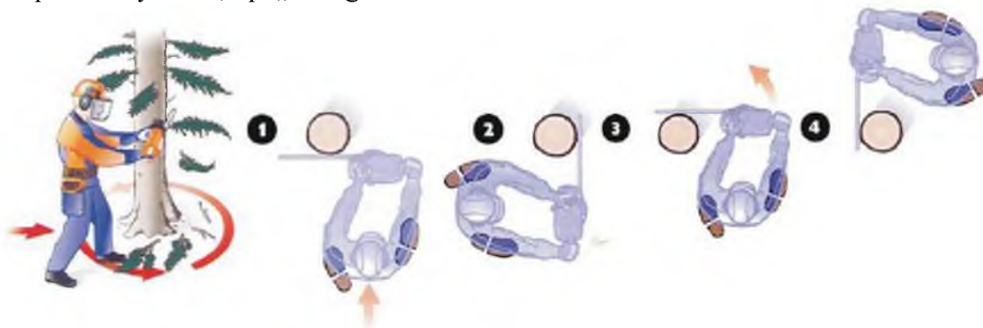
Rys.6 Technika podkrzesywania drzewa z zastosowaniem pilarki
